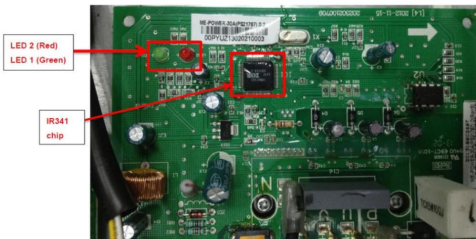
**LED1:** Störungsanzeige des Wechselrichtermoduls. Die Lampe ist aus, wenn das System normal läuft. Wenn das Wechselrichtermodul fehlerhaft ist, wird es eingeschaltet und der Fehlercode wird auf der Digitalröhre angezeigt.
