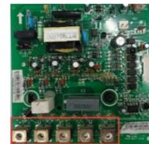
3. Die normale Spannung zwischen F0 und GND beträgt 3,1 V.
